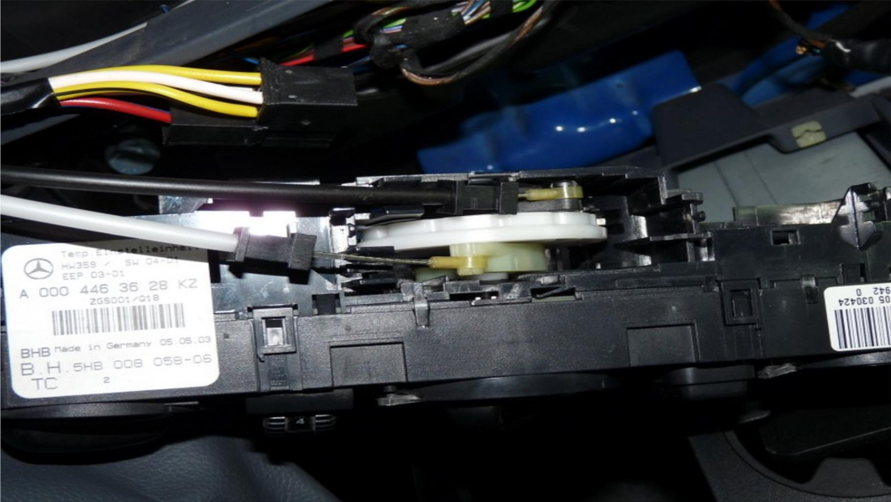
Nettoyez les cames en plastique donnez de la souplesse au ressort, faire fonctionner les câbles à la main, peut être mettre un lubrifiant au silicone
