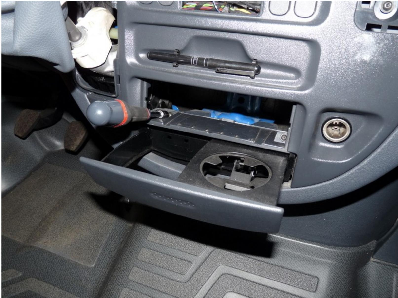
Tirez délicatement sur la facade et vous avez accès aux commandes de ventilation, juste 2 vis à enlever, les connections de derrière, et les 2 câbles
