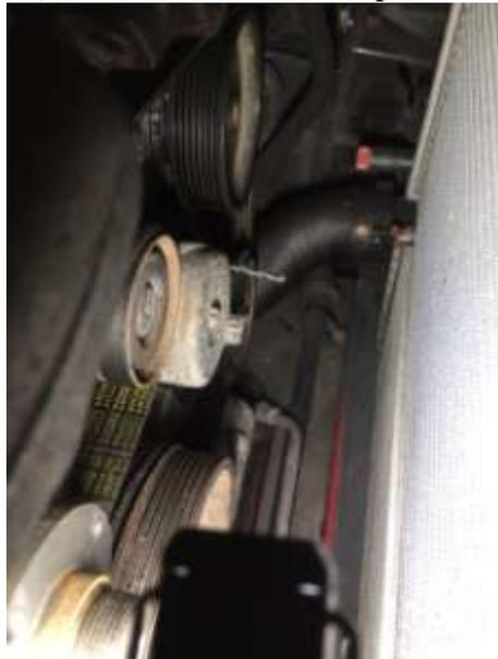
\_ on peut retirer la grande courroie, les deux galets fixes (j'ai pris un clou de 2mm de diamètre pour faire sauter leurs couvercles et accéder à leur vis de fixation), le tendeur.
