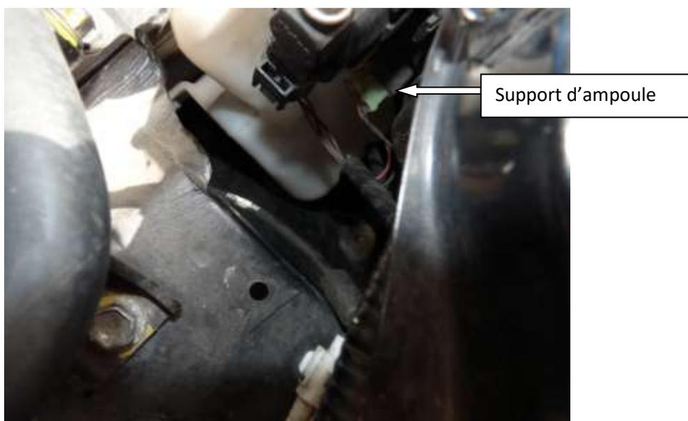
Maintenant l'ampoule de sortie, reste plus qu'à la remplacer, et, le remontage se fait plus rapidement, normal
