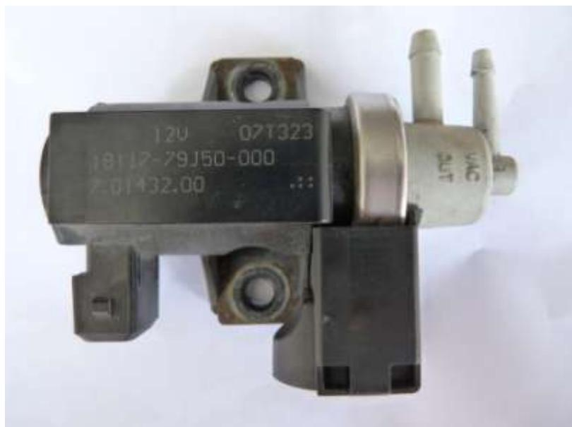
Cette commande fonctionne par dépression, et le calculateur . Vérifier que la bobine est bonne. J'en profite pour changer tous les tuyaux venant de la pompe à dépression
