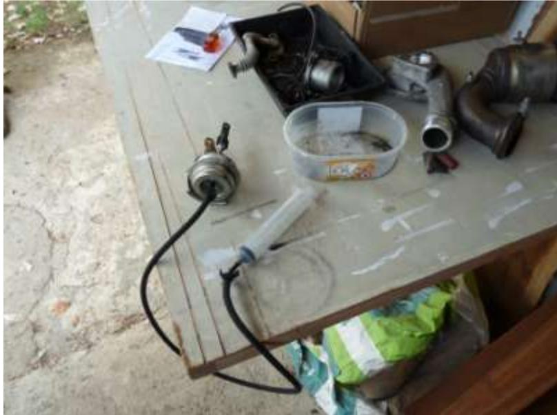
Vérification du bon fonctionnement de la commande à dépression, voir si elle tient bien en dépression, c'est très important
