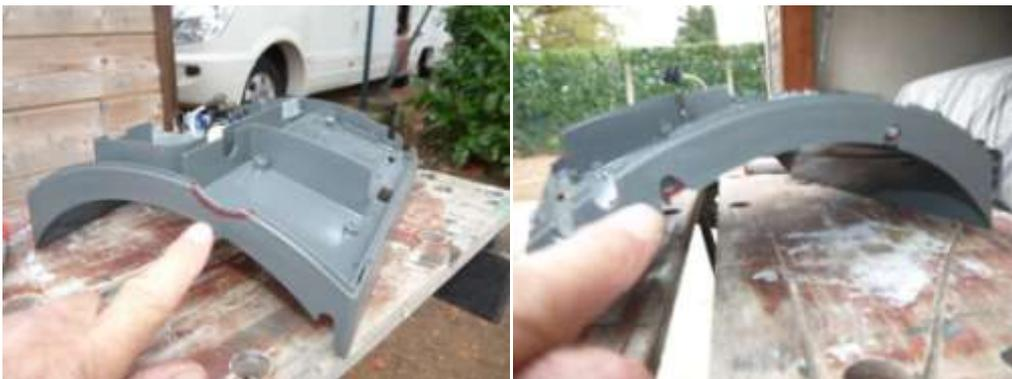
Meuler 4mm environ, le passage du moteur électrique, et à l'opposé, agrandir les trous. Ce ci facilite la remise en place du boitier
