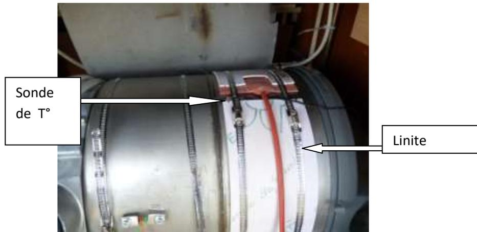
Maintenant, passer au remontage. Sur l'enveloppe, pratiquer petites découpes, pour faire sortir les fils des résistances, et la sonde, et faire sortir les vis des colliers. Repositionner l'enveloppe le mieux possible.
